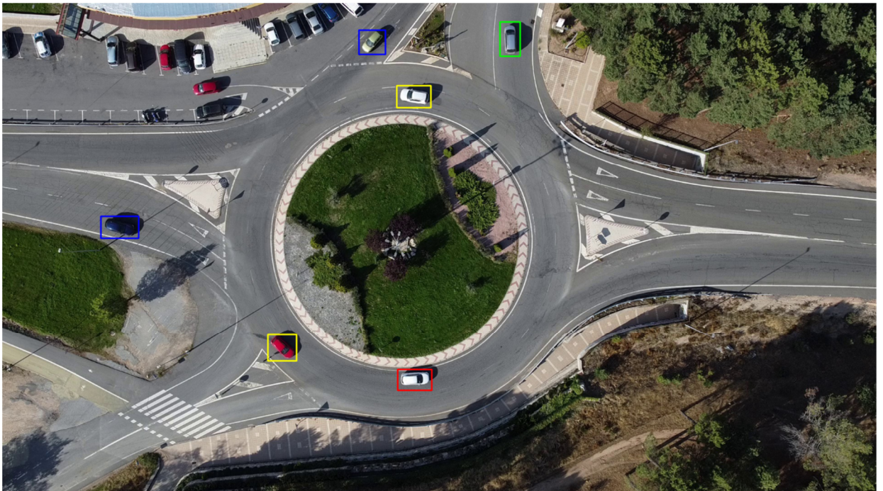
Figura 15. Vehículos pertenecientes a cada área (azul: entrada, verde: salida, amarillo: tráfico circulante, rojo: resto).
