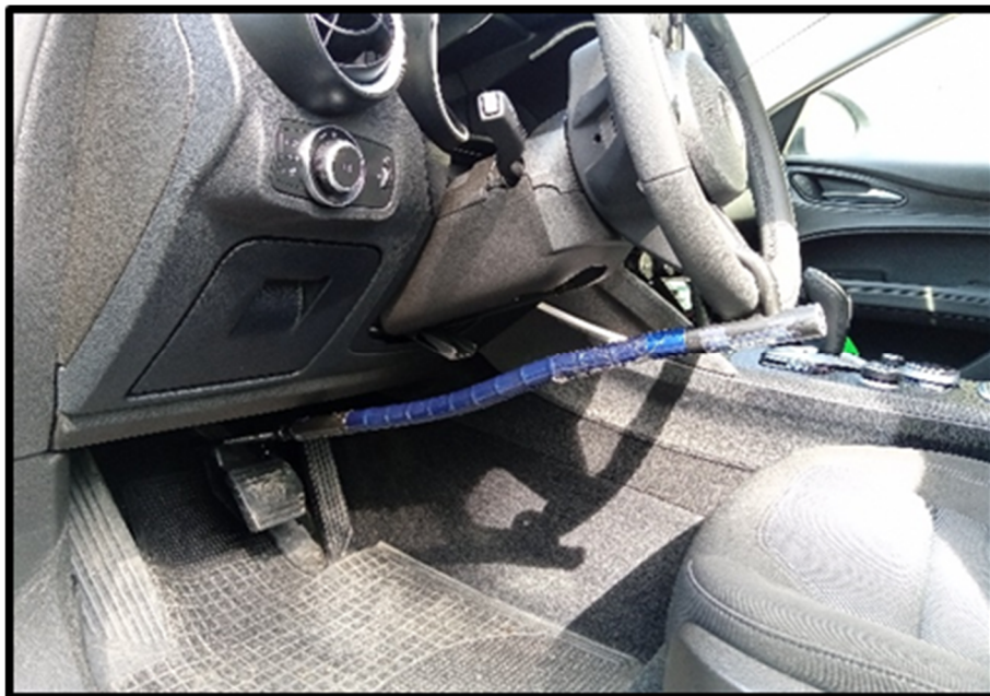
Imagen n° 7: Colocación del inmovilizador tipo “cepo volante-pedal” en un vehículo. Fuente: Elaboración propia.
