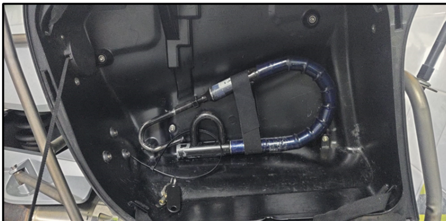
Imagen n°4: Propuesta de sujeción del inmovilizador en interior maleta lateral de motocicleta. Fuente: Elaboración propia.
