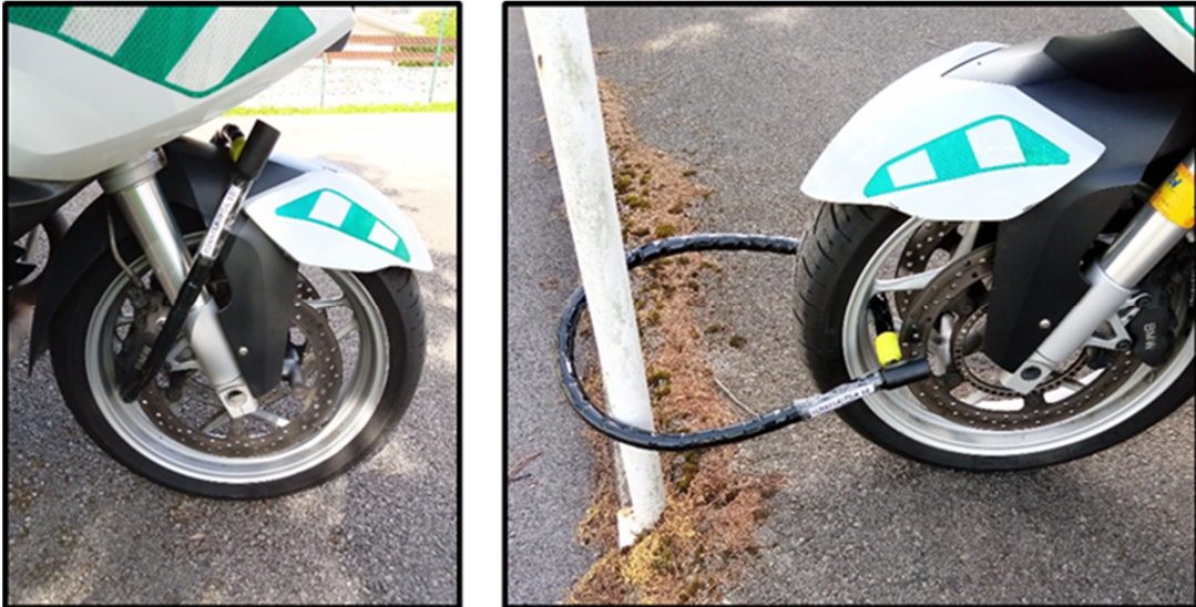
Imagen n° 5 y 6: Colocación del inmovilizador tipo “pitón” en la rueda delantera de una motocicleta. Fuente: Elaboración propia.
