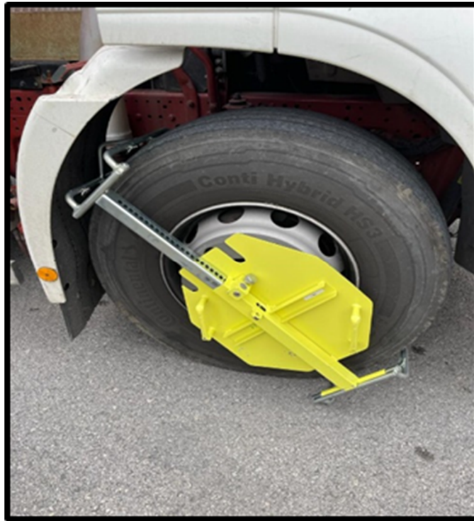
Imagen n° 8: Colocación del inmovilizador tipo “cepo de rueda” en un camión. Fuente: Elaboración propia.
